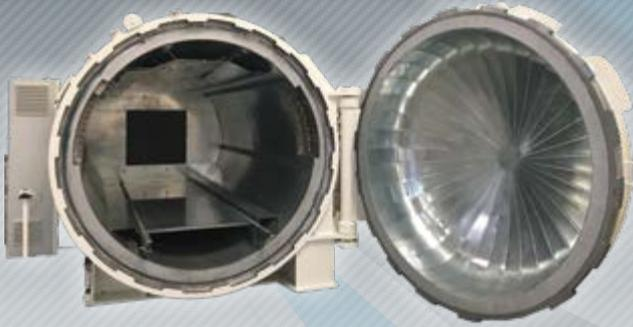
Aeroform est spécialisé dans la fabrication d'autoclaves à air sec ( air ou azote) de toutes dimensions pouvant atteindre des températures de 450°C et des pressions jusqu'à 40 bar.
