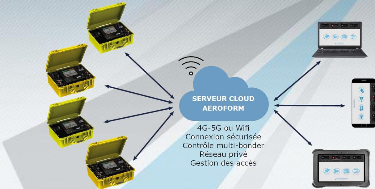
L'application AERO CLOUD BONDING permet la gestion et la supervision de plusieurs hot bonders à la fois, à distance et sur différents appareils via un serveur cloud privé et sécurisé.
